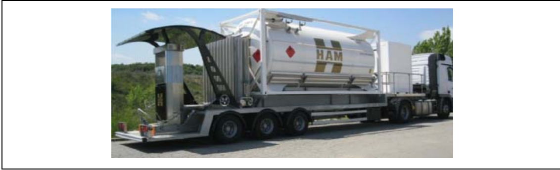
FIGURA 15. Estación móvil de GNL
